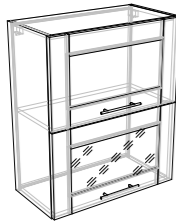
ШКАФ НАСТЕННЫЙ ГОРИЗОНТАЛЬНОЕ ОТКРЫВАНИЕ ВСТАВКА ЛДСП и СТЕКЛО Д600xГ308xВ720
