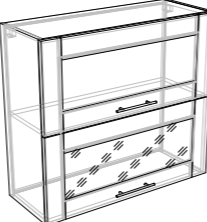
ШКАФ НАСТЕННЫЙ ГОРИЗОНТАЛЬНОЕ ОТКРЫВАНИЕ ВСТАВКА ЛДСП и СТЕКЛО Д800xГ308xВ720
