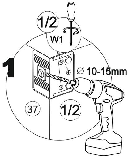
*Просверлите заднюю стенку сверлом  $\phi 10-15$  мм в центре прямоугольного отверстия на навесе.*
