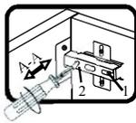
Если створка наклонена вправо или влево относительно вертикали корпуса, нужно выправить наклон створки в направлении А-А винтом 2.
