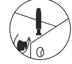
Схема сборки эксцентриковой стяжки
