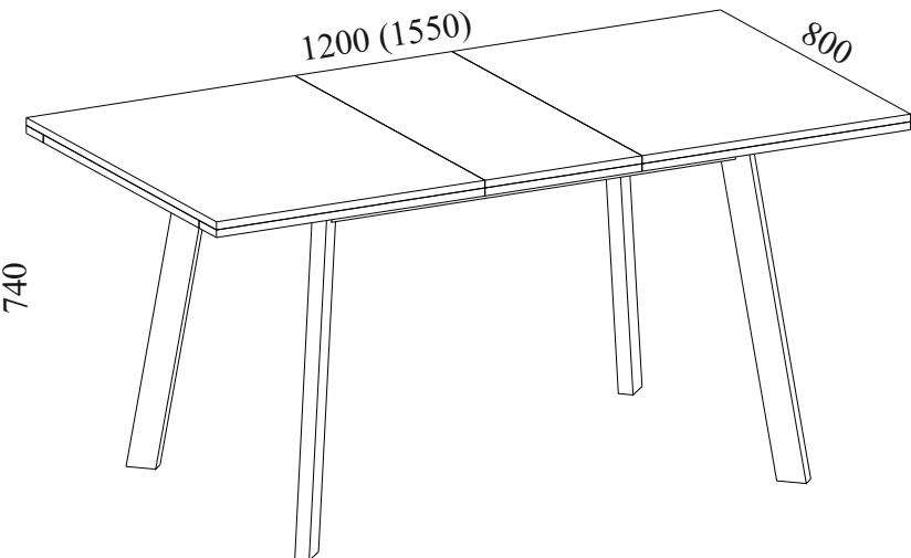
Габаритные размеры: ширина - 1200(1550) мм, высота - 740 мм, глубина - 800 мм.
