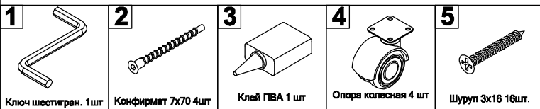
Ключ шестигран. 1 шт Конфирмат 7x70 4шт Клей ПВА 1 шт Опора колесная 4 шт Шуруп 3x16 16шт.
